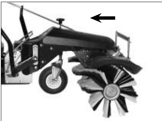
1) Nad kołem podporowym znajduje się rękojeść krótka z obłym chwytem do regulacji nacisku szczotki.
