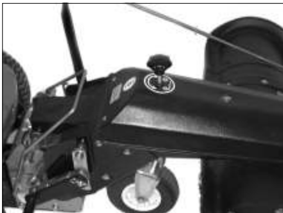
3) Optymalny nacisk szczotki: Szczotkę należy obniżyć do takiej wysokości, aby dokładnie równo dotykała podłoża. Wtedy jeszcze o 3 obroty obrócić przeciwnie do ruchu wskazówek zegara w kierunku pokazanym strzałką (-).
