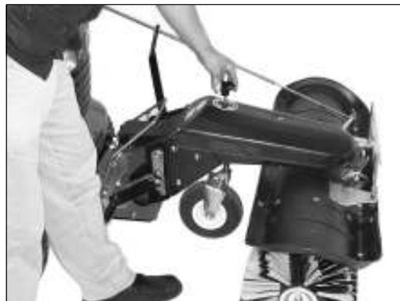
2) Wysokość koła podporowego można regulować obracając rękojeścią krótką z obłym chwytem.
